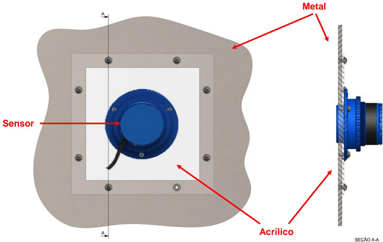
Figura 1 Figura 2 - Instalação do WCS-200
