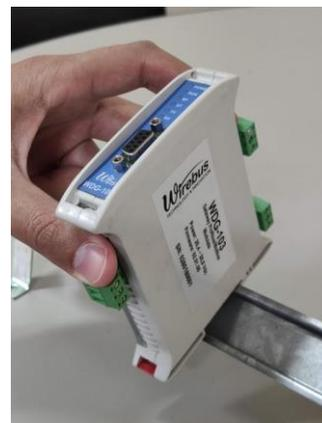
Utilizando uma chave de fenda, puxe a trava que se localiza na parte inferior do WDG-103. Após puxar a trava, fixe o WDG-103 na parte inferior do trilho DIN.
